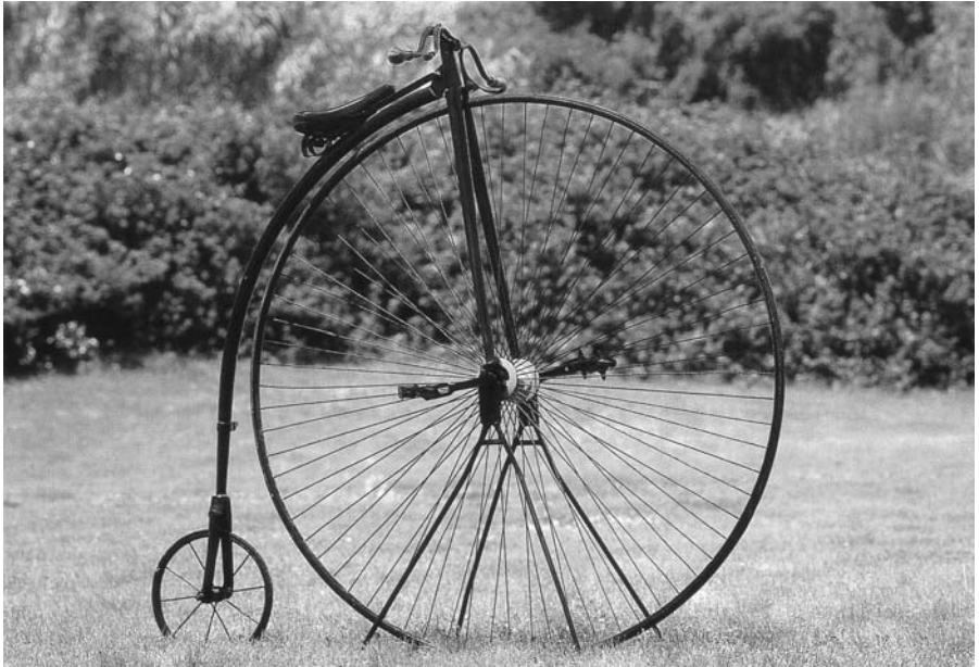
O biciclo, nos meados do século dezanove, todo em ferro, com diâmetros desproporcionados das rodas e os pedais inseridos no eixo da roda dianteira
